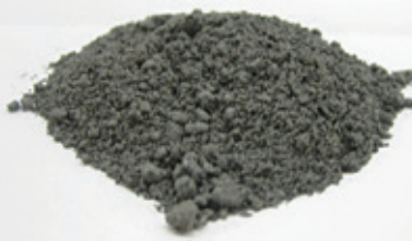
ジェイサンド外観 (松島火力発電所産)
